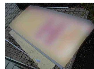
←パネルの変形、ズレ、破損の他、パネルの押さえ枠が変形し落下する場合も。
