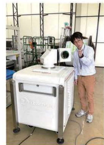
海上の風況調査に用いる レーザー照射装置
